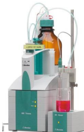
Slika 11. Prikaz aparature koja se koristila tijekom potenciometrijske titracije [18.]
