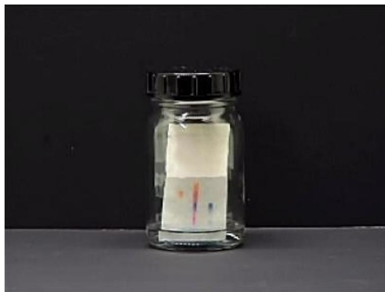
Slika 26. Razvijanje kromatograma
