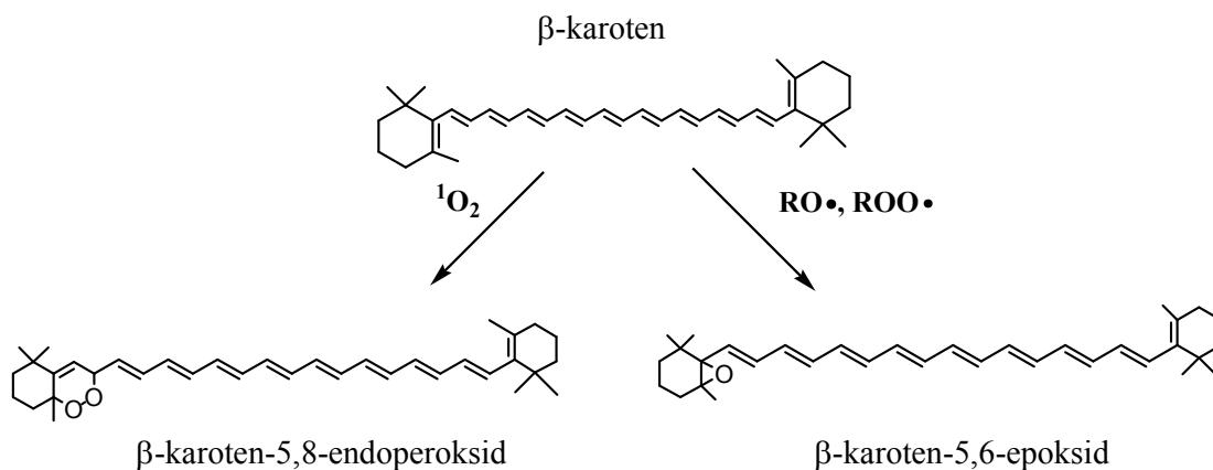
Slika 19. Mehanizam antioksidacijskog djelovanja  $\beta$ -karotena
