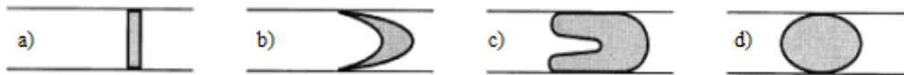
Slika 1. a) injektirani uzorak; b) disperzija konvekcijom; c) disperzija konvekcijom i difuzijom; d) disperzija difuzijom
