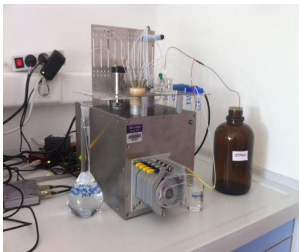
Slika 9. FIA analizator vlastite izrade
