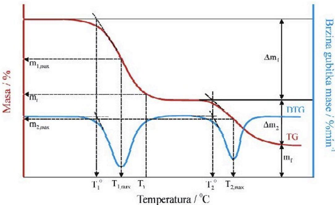
Slika 12. Općeniti oblik termograma s karakterističnim točkama
