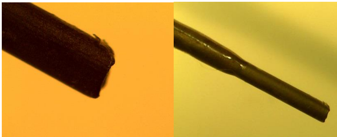
Slika 9. Mikroskopska slika MWCNT tenzidne elektrode pod različitim uvećanjem
