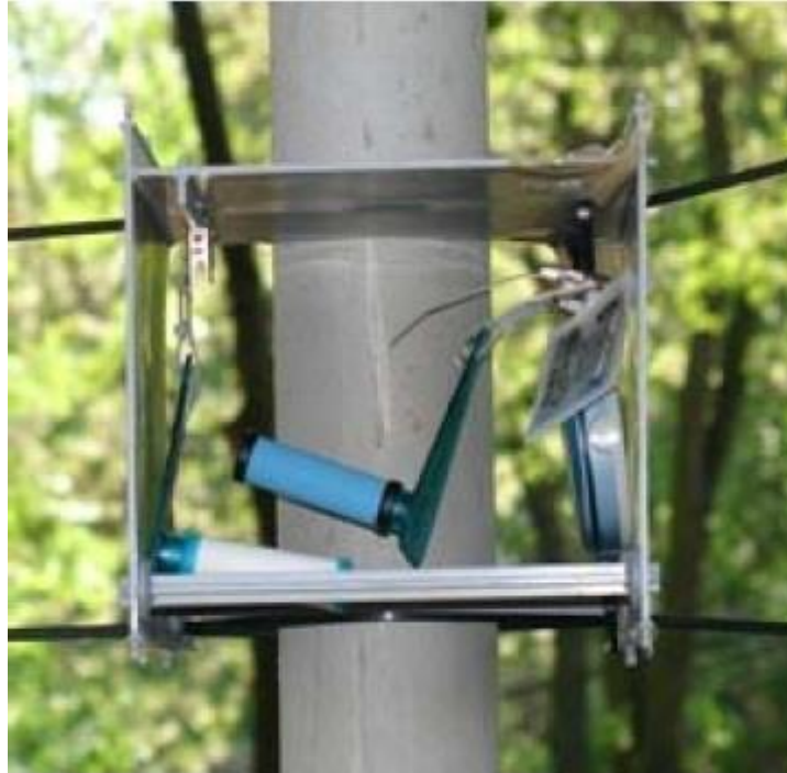
Slika 3.4. Prijedlog postavljanja vanjskog uzorkivača
