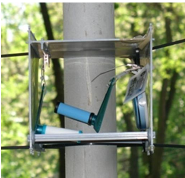
Slika 3.2.1.5. Sistem natkrivanja uzorkivača [24]
