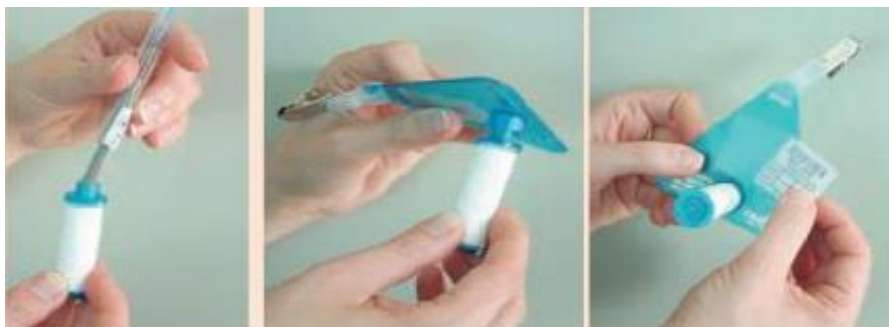
Slika 3.2.1.4. Postupak sastavljanja uzorkivača [24]
