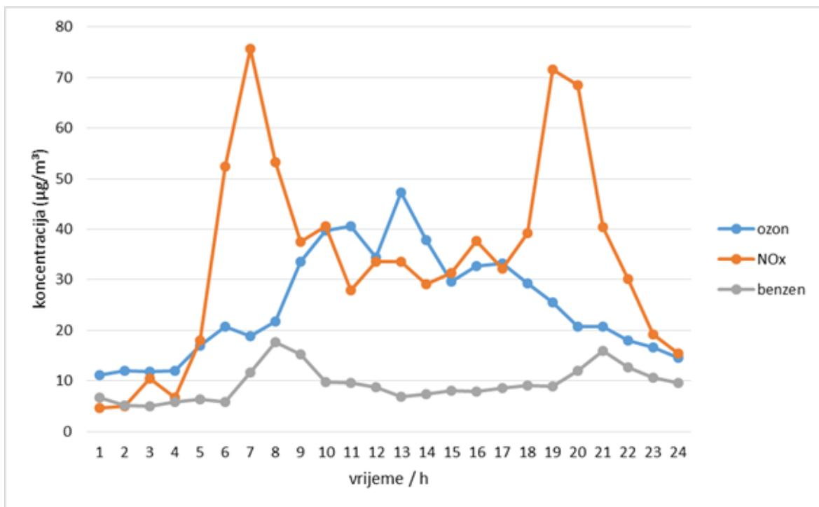
Slika 3.3.4. Dnevni hod koncentracija benzena ( $[\text{C}_6\text{H}_6] = \mu\text{g}/\text{m}^3 \cdot 10$ ), ozona i  $\text{NO}_x$  na automatskoj mjernoj postaji OSIJEK-1
