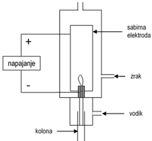
Slika 3.2.3.1. Plameno-ionizacijski detektor
