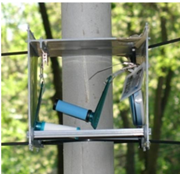
Slika 3.2.1.5. Sistem natkrivanja uzorkivača [24]
