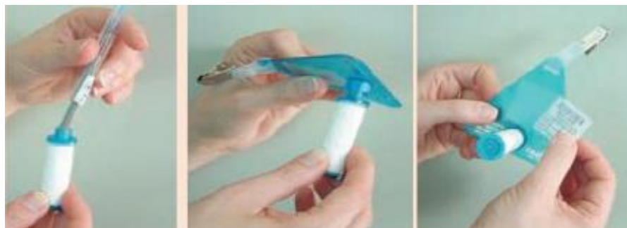
Slika 3.2.1.4. Postupak sastavljanja uzorkivača [24]
