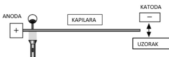
**Slika 4.** Kapilarna elektroforeza [7].
