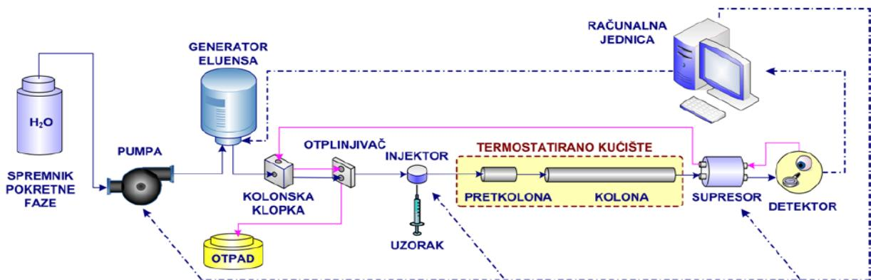
**Slika 3.** Moderni ionski kromatografski sustav s detektiranjem vodljivosti [4].
