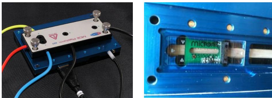
**Slika 14.** a) Platforma mikročipa, b) Unutrašnjost platforme s mikročipom [33].
