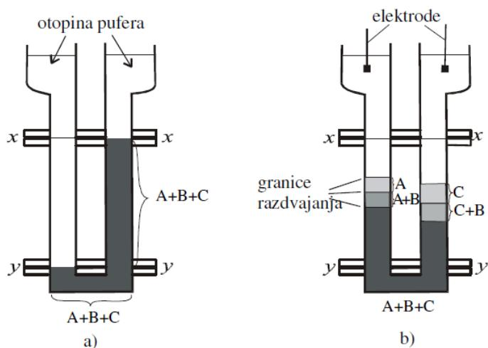
**Slika 6.** Shematski prikaz elektroforeze u slobodnoj otopini: a) ćelija napunjena otopinom pufera i otopinom analita prije elektroforeze, b) ćelija napunjena otopinom pufera i otopinom analita nakon elektroforeze [12].
