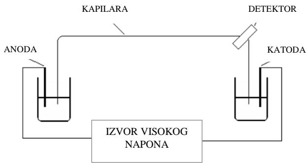
Slika 7. Shematski prikaz elektroforeze u kapilari [19].
