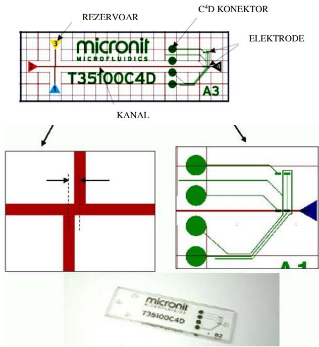
**Slika 16.** Mikročip korišten u elektroforetskim mjeranjima [34].
