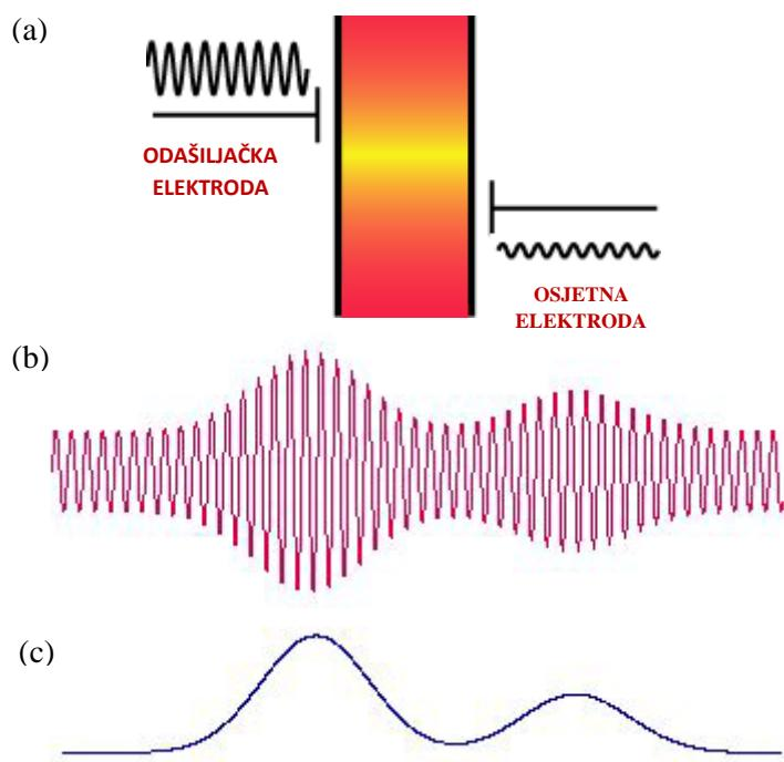
**Slika 11.** Shematski prikaz  $C^4D$  detektora: a) prenošenje signala između odašiljačke i osjetne elektrode, b) dobiveni signal na elektrodi, c) amplituda primljenog signala izmjenične struje nakon pretvaranja u signal istosmjerne struje [27].
