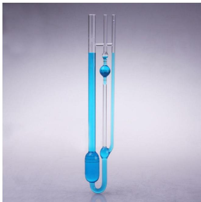
*Slika 18. Ubbelohdeov viskozimetar*
