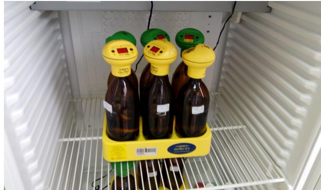
Slika 1.21. OxiTop senzori na bocama s uzorcima za određivanje BPK<sub>5</sub> vrijednosti na magnetskom postolju unutar termostatiranog ormarića
