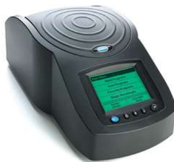
Slika 1.11. HACH DR 2500 spektrofotometar [15]
