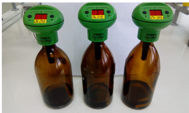
Slika 1.7. OxiTop BPK mikroprocesori
