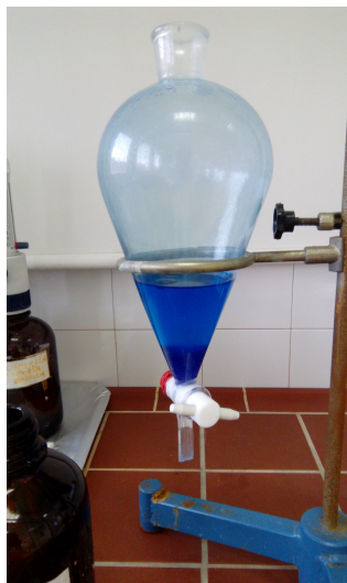
Slika 1.23. Ekstrakcija ionskog asocijata iz alkalne otopine uz miješanje s kiselom otopinom metilenskog modrila
