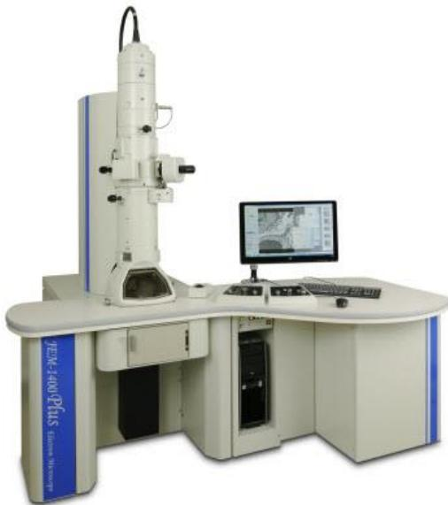
*Slika 18. Transmisijski elektronski mikroskop*
