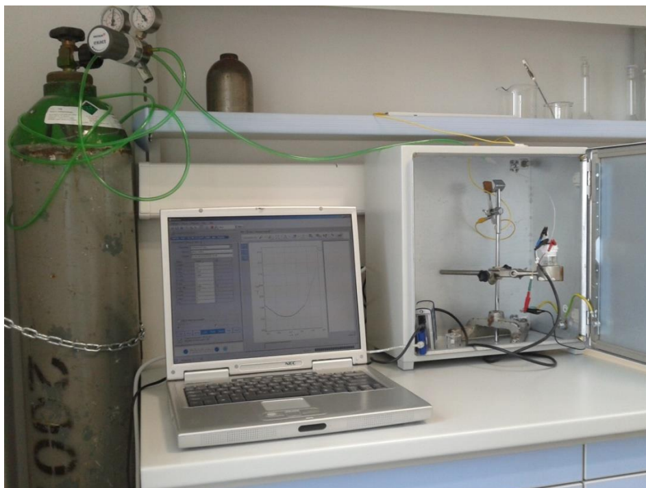
Slika 4. Prikaz aparature korištene za diferencijalnu pulsnu voltametriju.
