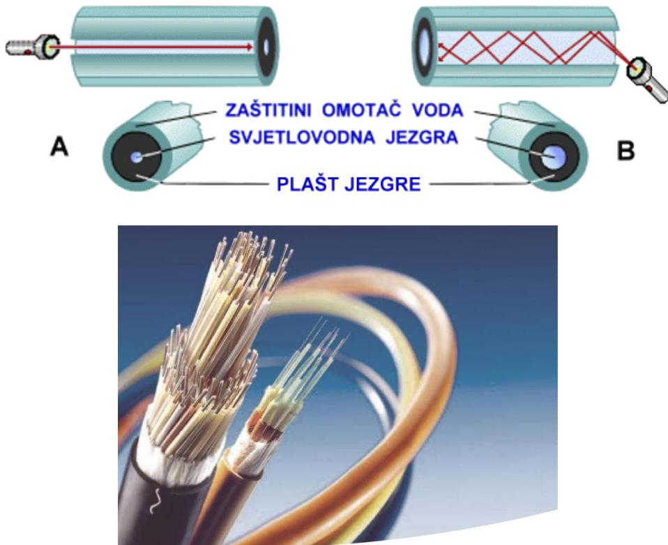
Slika 19. Optički komunikacijski kabel [19].
