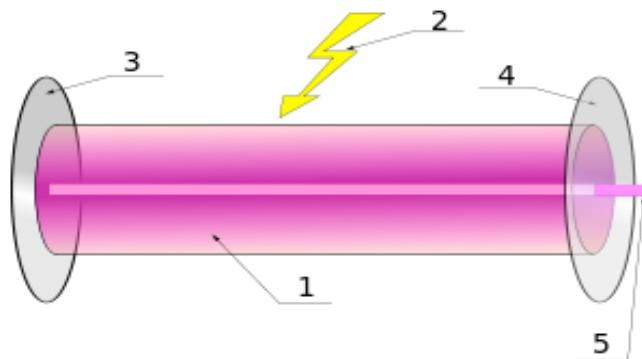
Slika 8. Shematski prikaz lasera [8].
