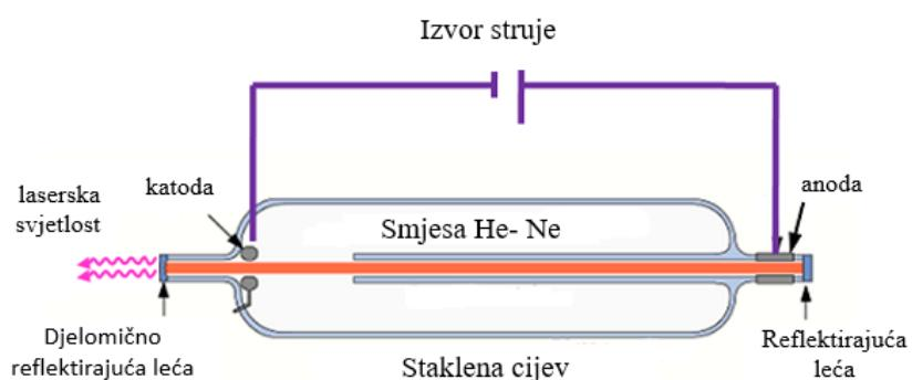
Slika 9. Prikaz helij- neonskog plinskog lasera [9].
