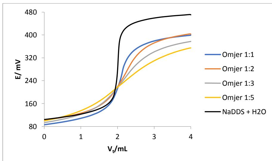
**Slika 13.** Prikaz titracijskih krivulja NaDDS-a,  $c = 4 \times 10^{-3}$  M, sa CPC-om,  $c = 4 \times 10^{-3}$  M, uz dodatak Genapola T110,  $c = 1 \times 10^{-2}$  M, u različitim molarnim omjerima u odnosu na NaDDS
