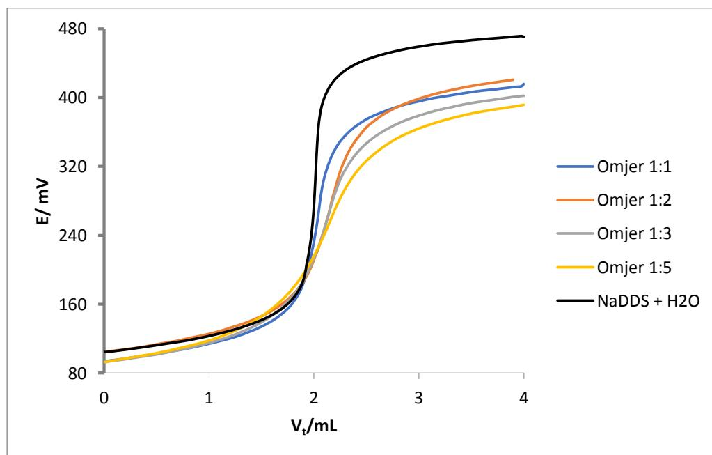
**Slika 11.** Prikaz titracijskih krivulja NaDDS-a,  $c = 4 \times 10^{-3}$  M, sa CPC-om,  $c = 4 \times 10^{-3}$  M, uz dodatak Genapola T080,  $c = 1 \times 10^{-2}$  M, u različitim molarnim omjerima u odnosu na NaDDS
