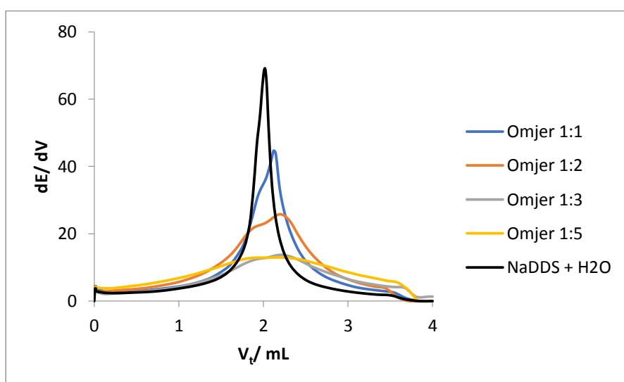
**Slika 14.** Prikaz prvih derivacija titracijskih krivulja NaDDS-a,  $c = 4 \times 10^{-3}$  M, sa CPC-om,  $c = 4 \times 10^{-3}$  M, i uz dodatak Genapola T110,  $c = 1 \times 10^{-2}$  M, u različitim molarnim omjerima u odnosu na NaDDS
