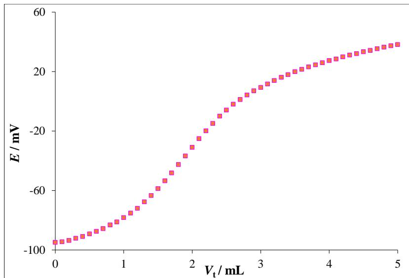
Slika 32. Prikaz titracijske krivulje dobivene pri monotonoj titraciji otopine uzorka 3 s dodanim NaDDS koncentracije  $1 \cdot 10^{-4}$  mol/L uz CPC koncentracije  $1 \cdot 10^{-4}$  mol/L kao titrant
