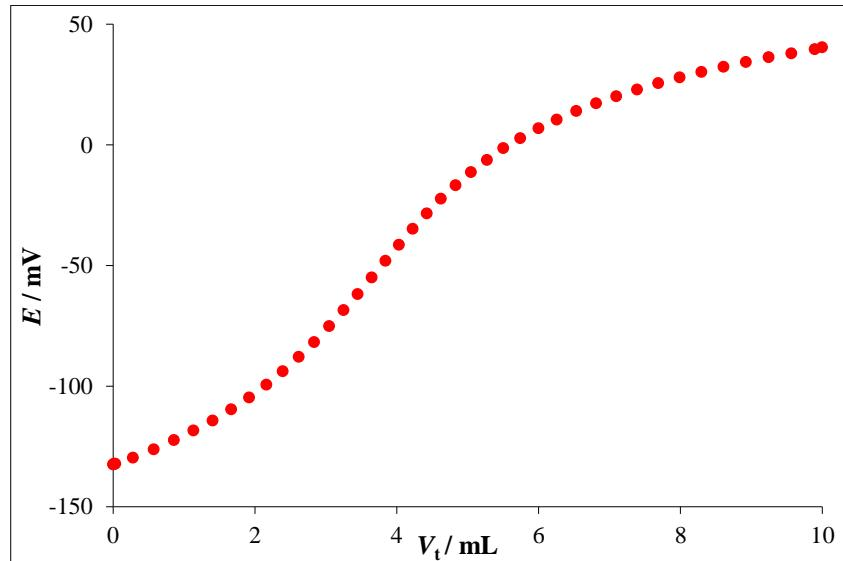
Slika 20. Prikaz titracijske krivulje dobivene pri dinamičkoj titraciji otopine uzorka 2 s dodanim NaDDS koncentracije  $1 \cdot 10^{-4}$  mol/L uz CPC koncentracije  $1 \cdot 10^{-4}$  mol/L kao titrant
