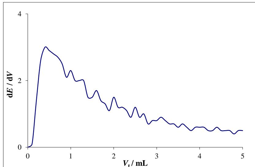
Slika 31. Prikaz krivulje prve derivacije dobivene pri monotonoj titraciji otopine uzorka 3 uz CPC koncentracije  $1 \cdot 10^{-4}$  mol/L kao titrant
