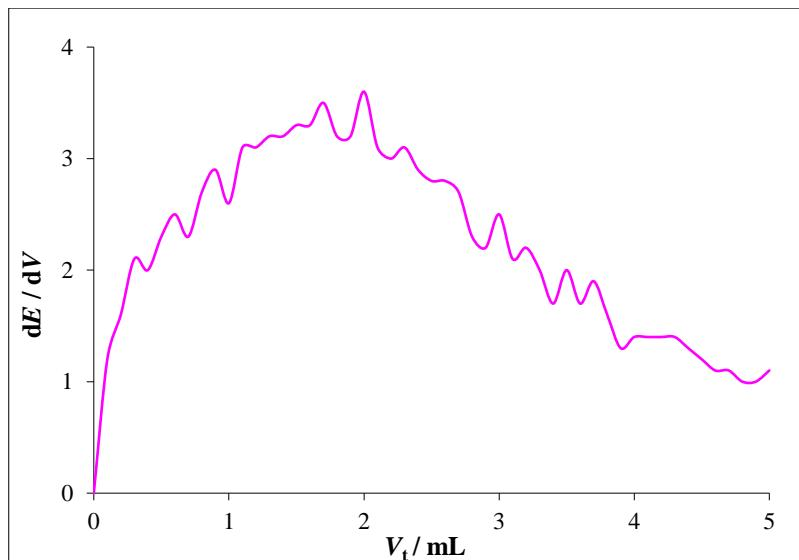
Slika 23. Prikaz krivulje prve derivacije dobivene pri monotonoj titraciji otopine uzorka 2 uz CPC koncentracije  $1 \cdot 10^{-4}$  mol/L kao titrant
