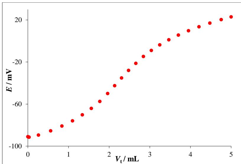
Slika 28. Prikaz titracijske krivulje dobivene pri dinamičkoj titraciji otopine uzorka 3 s dodanim NaDDS koncentracije  $1 \cdot 10^{-4}$  mol/L uz CPC koncentracije  $1 \cdot 10^{-4}$  mol/L kao titrant
