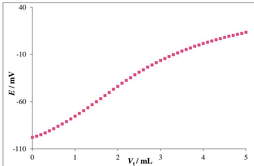
Slika 22. Prikaz titracijske krivulje dobivene pri monotonoj titraciji otopine uzorka 2 uz CPC koncentracije  $1 \cdot 10^{-4}$  mol/L kao titrant
