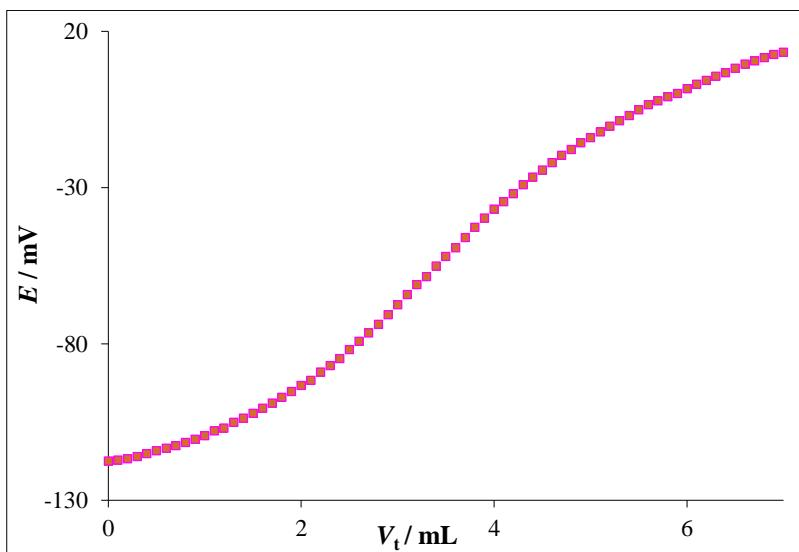
Slika 24. Prikaz titracijske krivulje dobivene pri monotonoj titraciji otopine uzorka 2 s dodanim NaDDS koncentracije  $1 \cdot 10^{-4}$  mol/L uz CPC koncentracije  $1 \cdot 10^{-4}$  mol/L kao titrant
