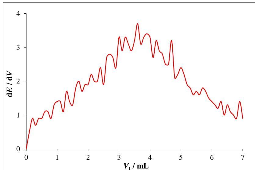
Slika 25. Prikaz krivulje prve derivacije dobivene pri monotonoj titraciji otopine uzorka 2 s dodanim NaDDS koncentracije  $1 \cdot 10^{-4}$  mol/L uz CPC koncentracije  $1 \cdot 10^{-4}$  mol/L kao titrant
