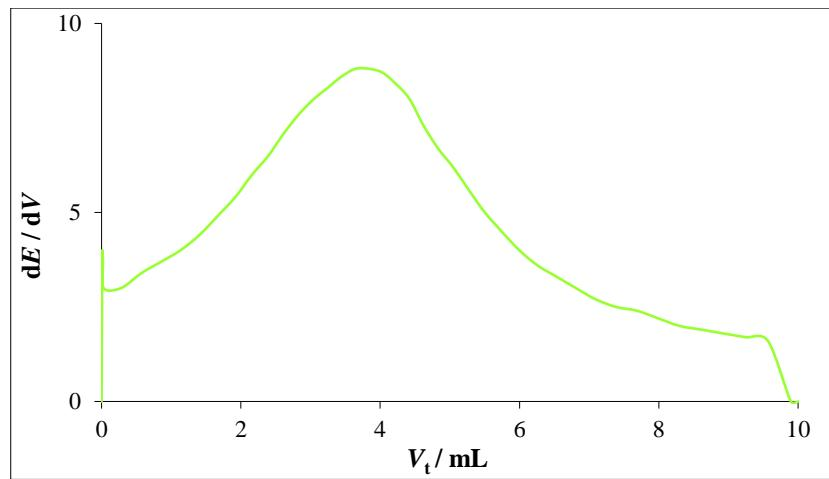
Slika 21. Prikaz krivulje prve derivacije dobivene pri dinamičkoj titraciji otopine uzorka 2 s dodanim NaDDS koncentracije  $1 \cdot 10^{-4}$  mol/L uz CPC koncentracije  $1 \cdot 10^{-4}$  mol/L kao titrant
