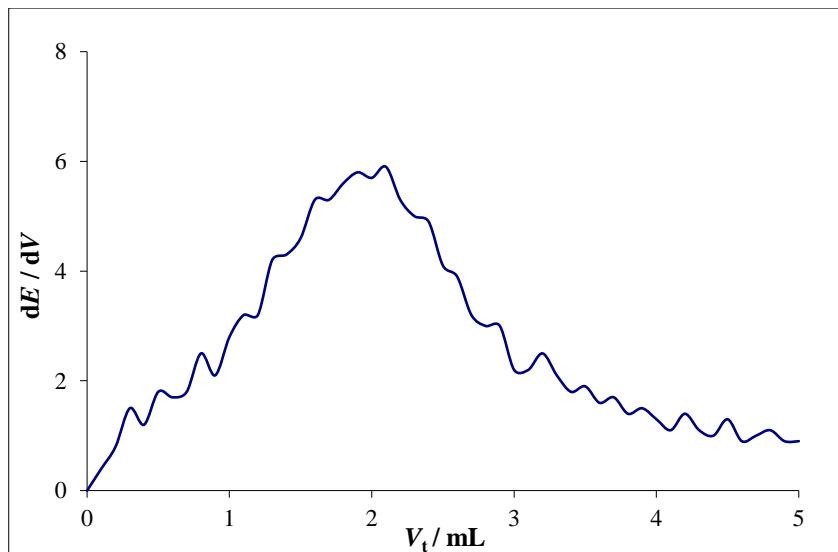
Slika 33. Prikaz krivulje prve derivacije dobivene pri monotonoj titraciji otopine uzorka 3 s dodanim NaDDS koncentracije  $1 \cdot 10^{-4}$  mol/L uz CPC koncentracije  $1 \cdot 10^{-4}$  mol/L kao titrant
