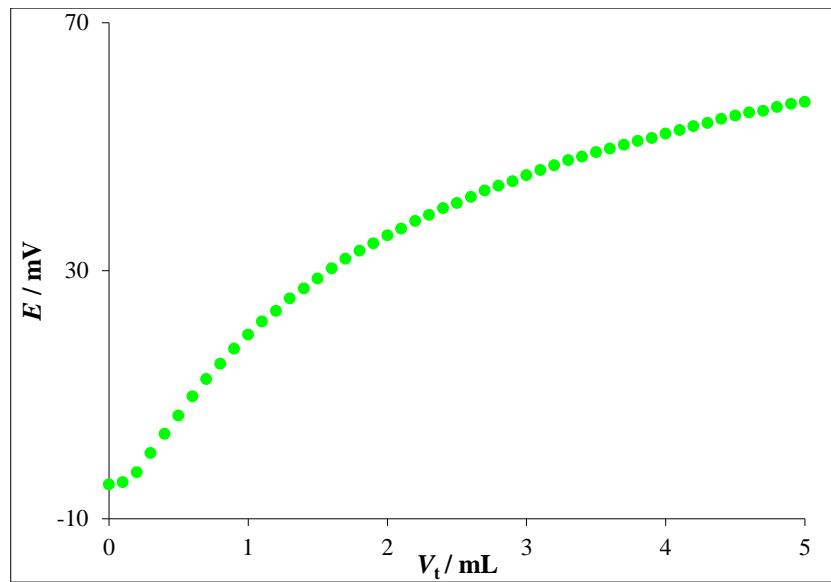
Slika 30. Prikaz titracijske krivulje dobivene pri monotonoj titraciji 2 mL otopine uzorka 3 uz CPC koncentracije  $1 \cdot 10^{-4}$  mol/L kao titrant
