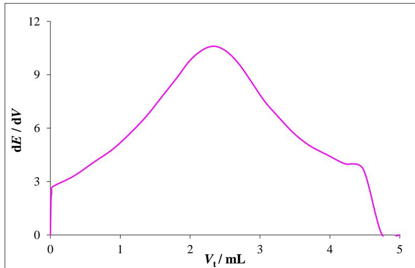
Slika 29. Prikaz krivulje prve derivacije dobivene pri dinamičkoj titraciji otopine uzorka 3 s dodanim NaDDS koncentracije  $1 \cdot 10^{-4}$  mol/L uz CPC koncentracije  $1 \cdot 10^{-4}$  mol/L kao titrant
