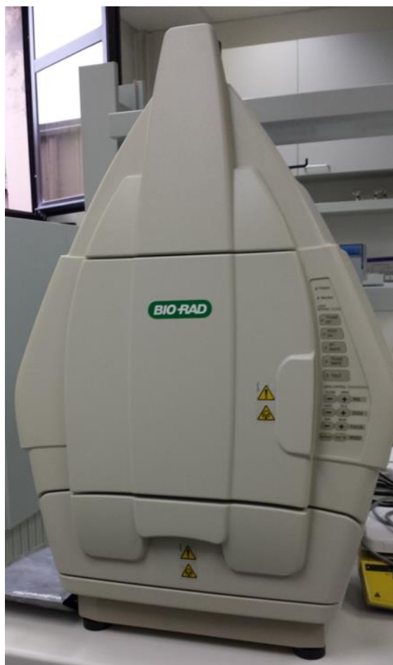
Slika 9. Kemoluminiscencijski uređaj za vizualizaciju rezultata
