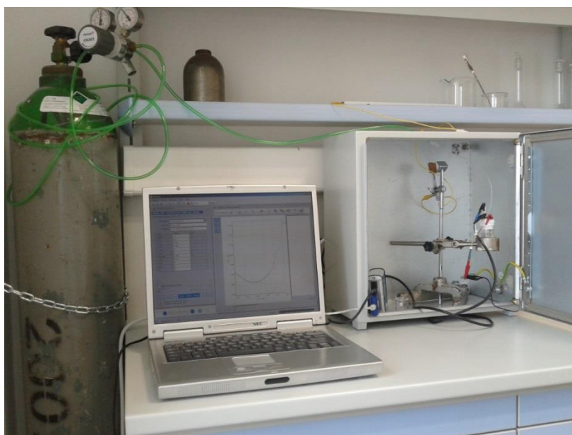
Slika 7. Prikaz aparature za diferencijalnu pulsnu voltametriju.
