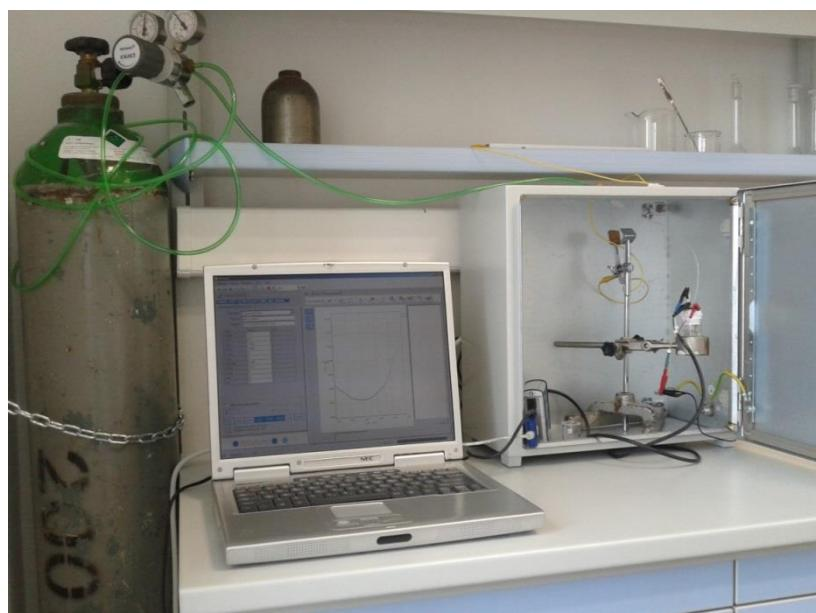
Slika 7. Prikaz aparature za diferencijalnu pulsnu voltametriju.
