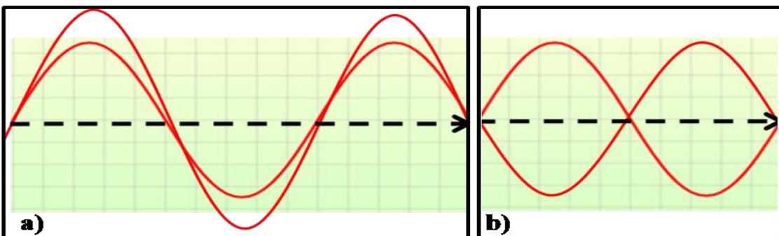
*Slika 8. – a) konstruktivna i b) destruktivna interferencija*
