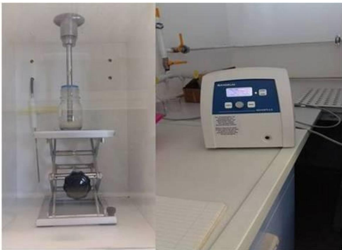
Slika 20. – ultrazvučni uređaj Bandelin sonopuls
