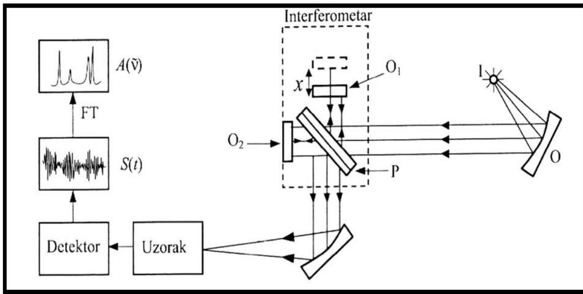
Slika 19. – Shema FT-IR spektrofotometra<sup>30</sup>
