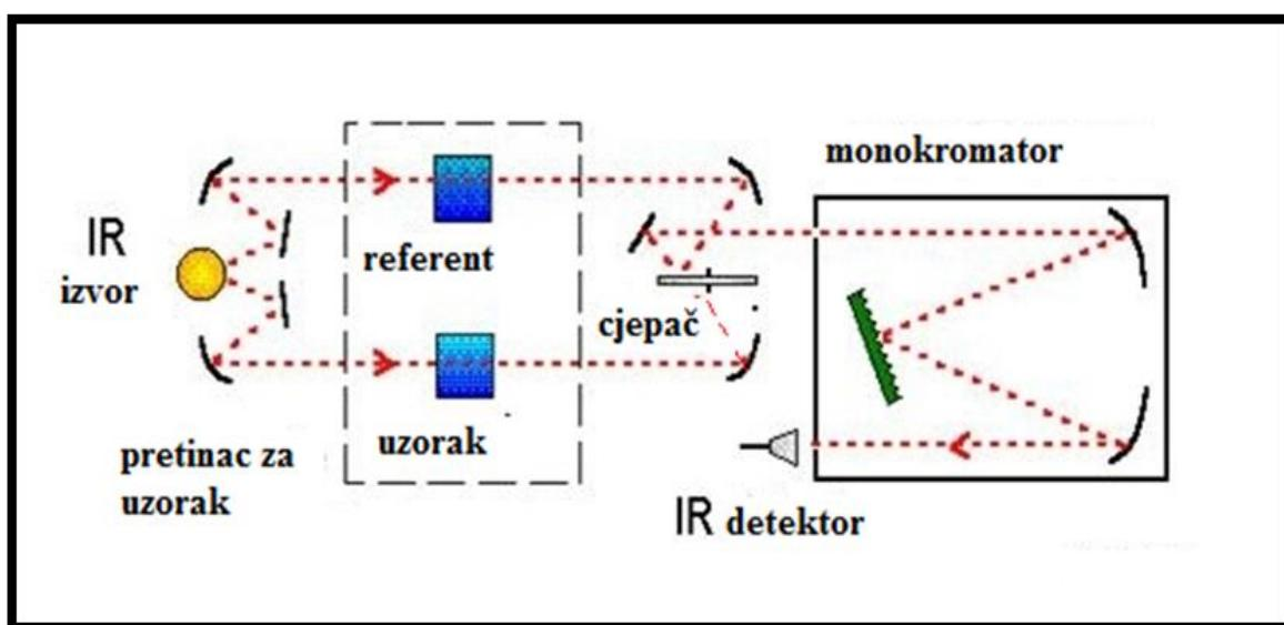
Slika 18. – Shema disperzivnog IR spektrofotometra<sup>29</sup>
