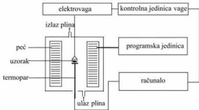
Slika 3. Shema TGA instrumenta<sup>17</sup>
