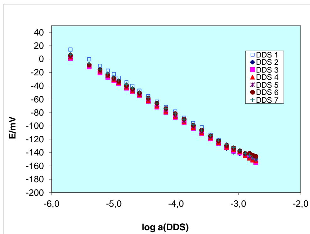
Slika 9. Odziv senzora na  $4 \cdot 10^{-3}$  M otopinu DDS-a
