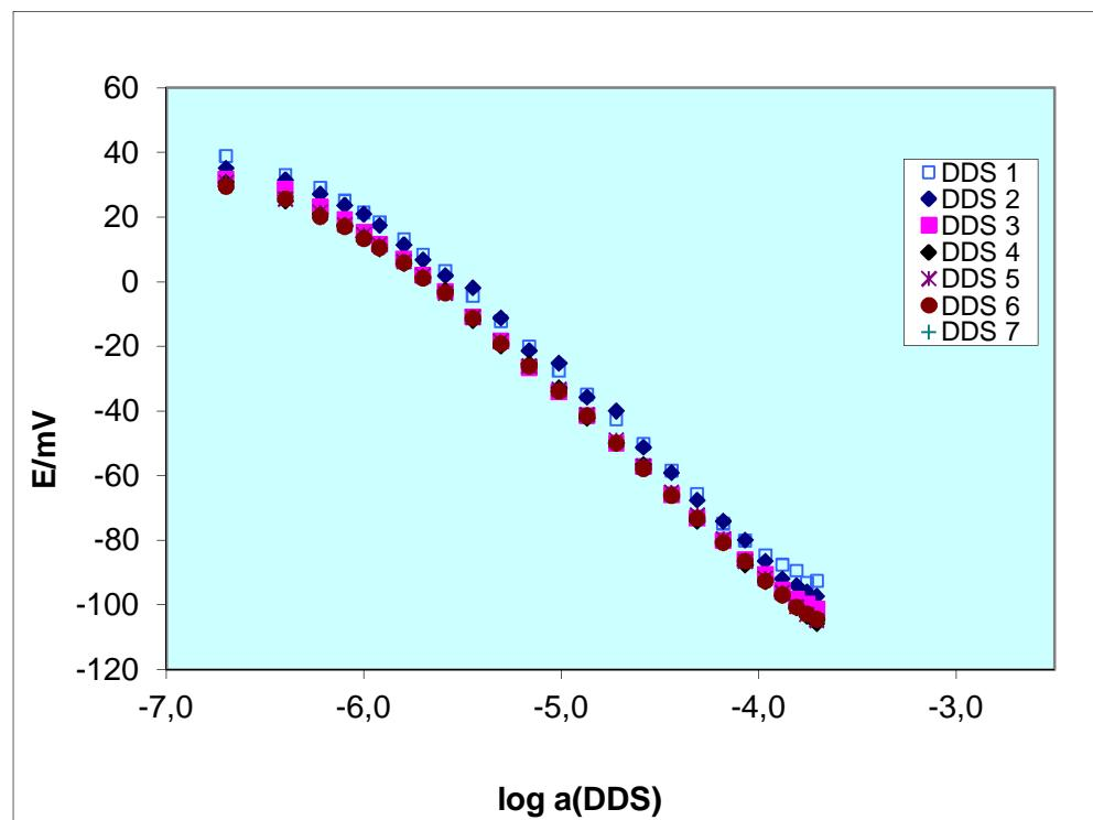
Slika 10. Odziv senzora na  $4 \cdot 10^{-4} \text{ M}$  otopinu DDS-a
