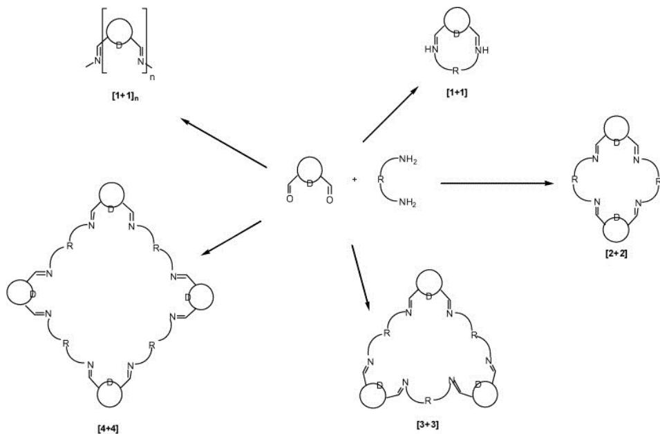
Slika 8. Prikaz nastajanja mogućih produkata kondenzacijom diamina i dialdehyda
