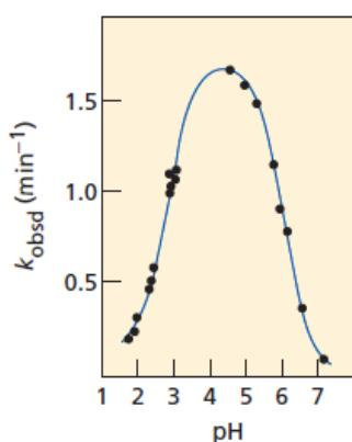
Slika 4. Ovisnost brzine sinteze Schiffovih baza o pH mediju
