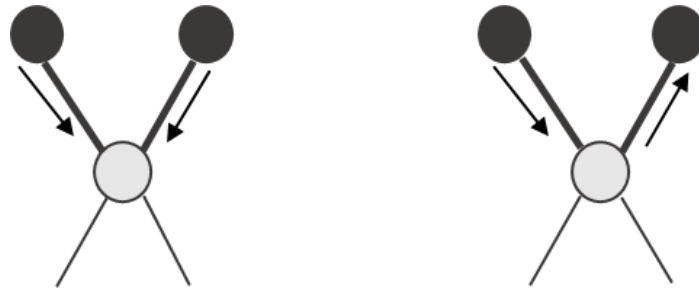
Slika 2. Shematski prikaz simetričnih i asimetričnih vibracija molekula
