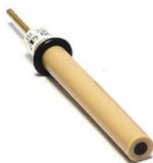
Slika 3.5. Radna elektroda od staklastog ugljika(ALS Co., Japan) [35].
