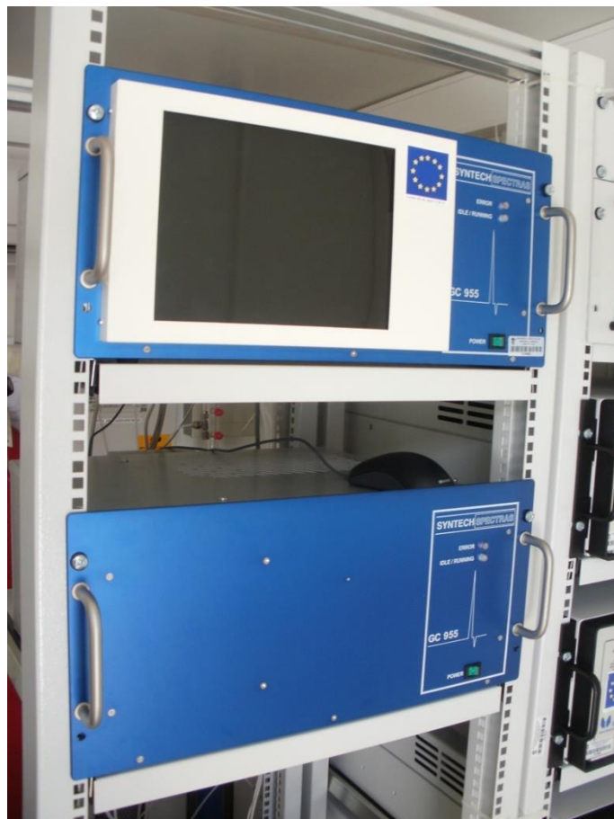
Slika 9. Uređaj za mjerenje koncentracije benzena [37].
