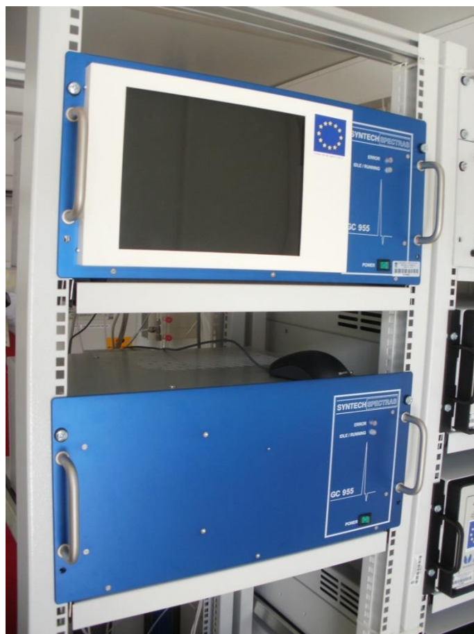
Slika 9. Uređaj za mjerenje koncentracije benzena [37].
