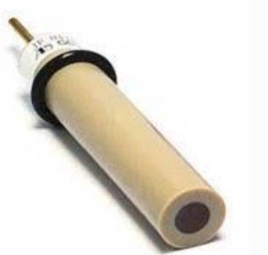
Slika 9. Radna elektroda od staklastog ugljika („glassy carbon“) [20].
