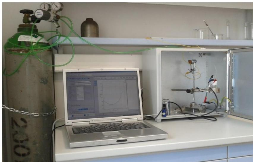
**Slika 8.** Prikaz aparature za voltametrijska mjerena (PalmSens potencijostat/galvanostat)
