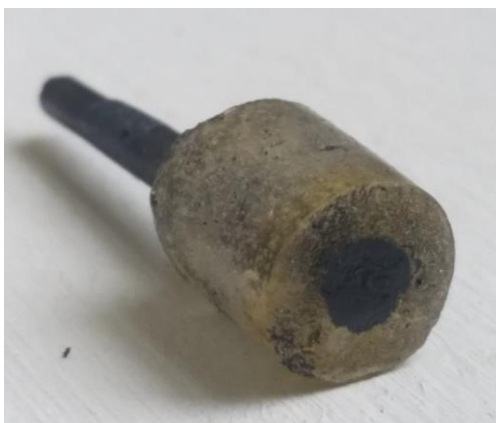
Slika 12. Prikaz MWCNT tenzidnog senzora.
