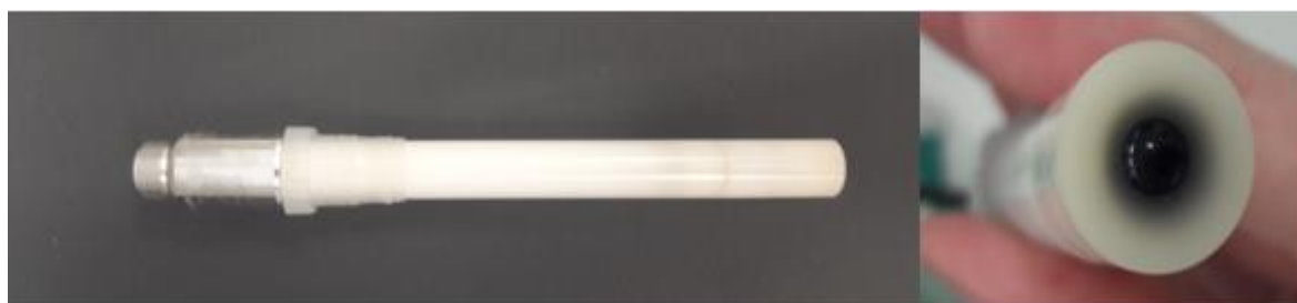
Slika 21. Izgled korištene Philipsove elektrode s ugrađenom tekućom DDA-TPB membranom s dodatkom ugljikovih nanočestica.
