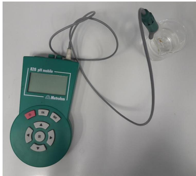
**Slika 23.** Korišteni pH metar, 826 pH Mobile.
