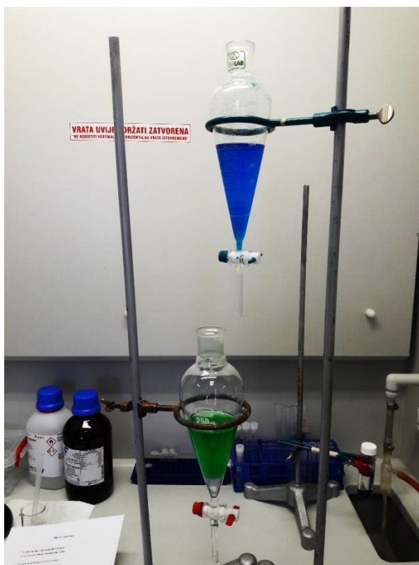
Slika 24. Aparatura za MBAS metodu.
