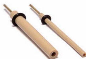
Slika 12. Radna elektroda od staklastog ugljika („glassy carbon“) [20].
