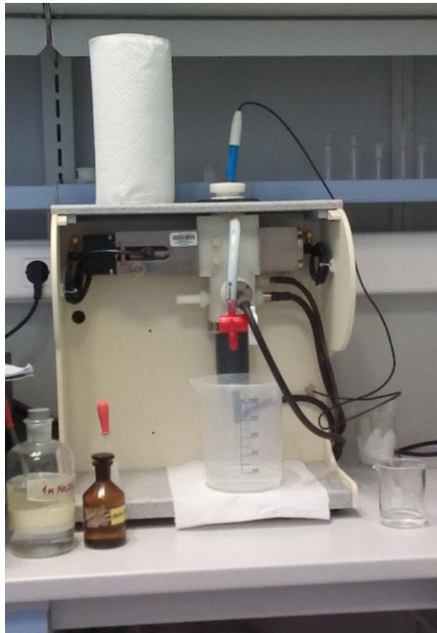
Slika 29. Akustični i elektroakustični spektrometar DT-1200, Dispersion Technology
