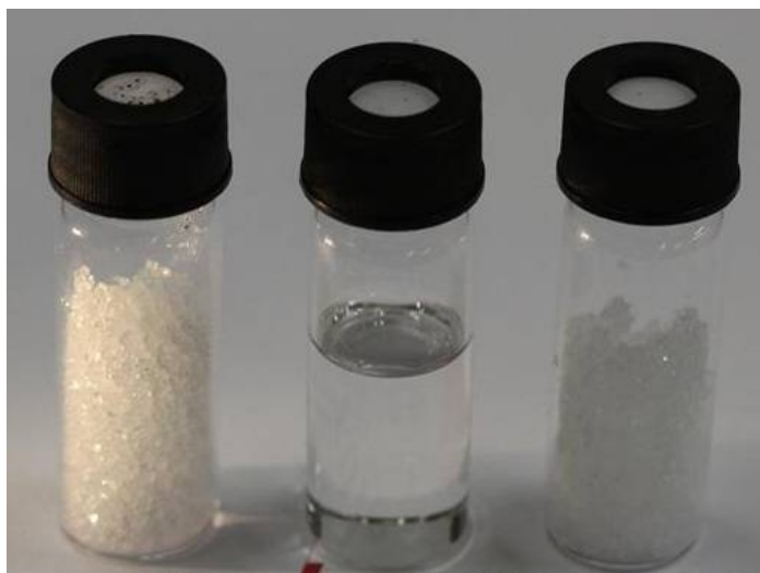
Slika 8. Komponente eutektičkog otapala (lijevo i desno), eutektičko otapalo nakon miješanja dviju komponenti (sredina)
