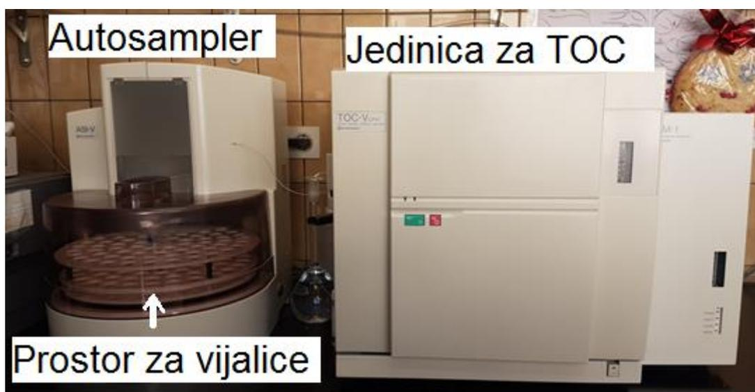
Slika 15. TOC analizator, Shimadzu, 2010.
