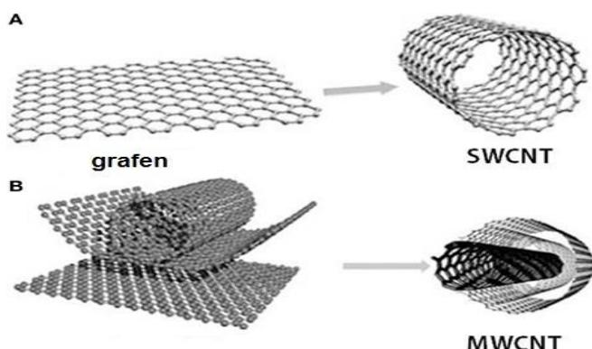
Slika 18. Cilindrične nanostrukture ugljika, a)grafen i jednostjenčana nanocjevčica, b) grafen i višestjenčana nanocjevčica.
