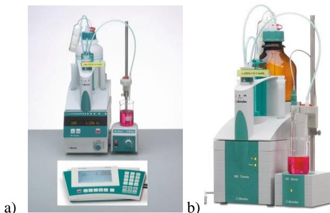
Slika 21. A) Prikaz aparature koja se koristila tijekom direktnе potenciometrije i; b) Prikaz aparature koja se koristila tijekom potenciometrijske titracije.
