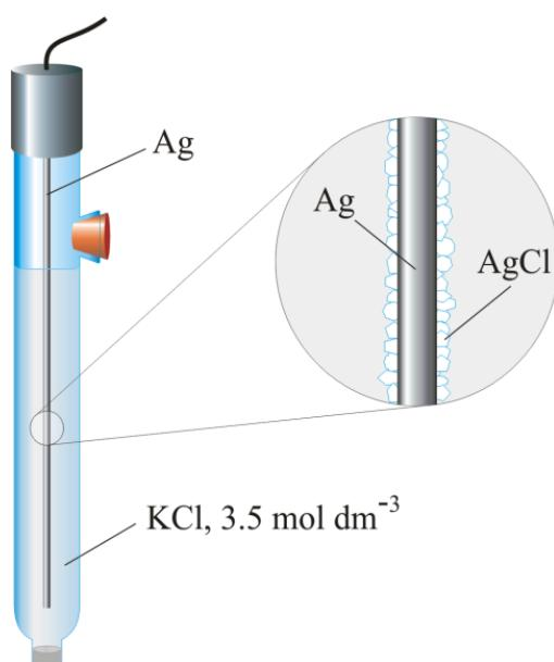
*Slika 14. Srebro/srebrov (I) klorid referentna elektroda, Ag/AgCl.*
