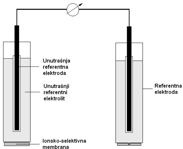
Slika 15. Elektrokemijska mjerna ćelija s ionsko-selektivnom elektrodom.
