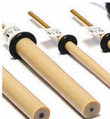
Slika 3.2. Radna elektroda- elektroda od staklastog ugljika.
