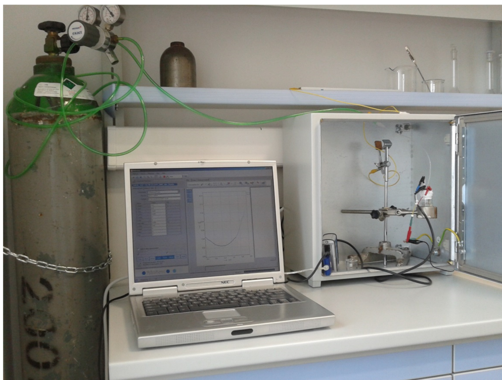
Slika 3.1. Prikaz aparature za provedbu elektrokemijskih mjerenja.
