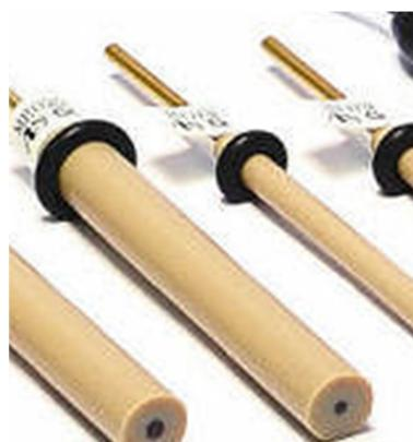
*Slika 3.2. Radna elektroda- elektroda od staklastog ugljika.*
