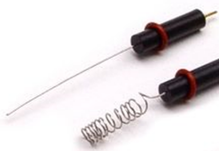
Slika 3.3. Protuelektroda – platinska žica.
