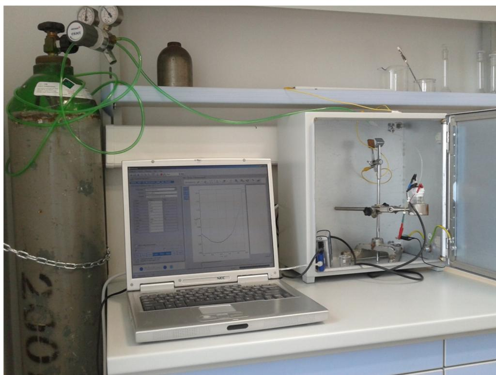
*Slika 3.1.* Prikaz aparature za provedbu elektrokemijskih mjerena.
