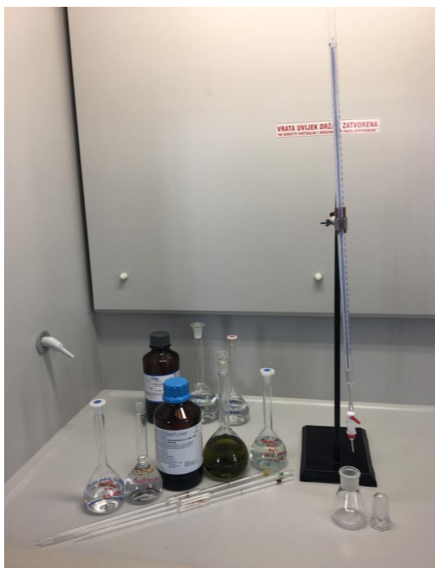
Slika 15: Prikaz korištene aparature za titraciju u dvije faze.
