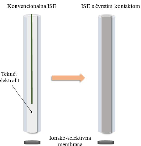
**Slika 10:** Usporedba građe konvencionalne ionsko selektivne elektrode i ionsko selektivne elektrode sa čvrstim kontaktom [5].
