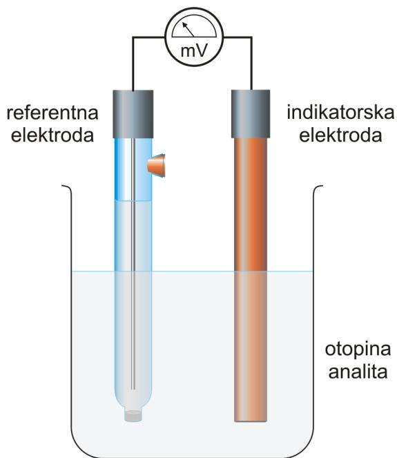
**Slika 7:** Elektrokemijska ćelija s 2 elektrode: referentna i indikatorska [17].
