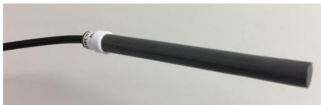
Slika 25: Izgled ionsko-selektivne elektrode za kationske tenzide sa čvrstim kontaktom i tekućom membranom [5].
