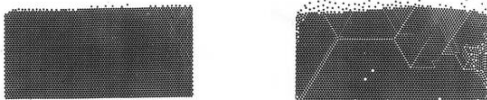
Slika 17. Lijevo idealni jedinični kristal i desno monokristal s defektima
