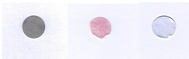
Slika 15. Izgled KBr pastila s različitim uzorcima tvari
