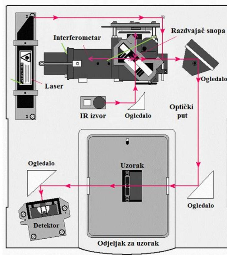
Slika 17. Shematski prikaz rada FTIR spektrofotometra
