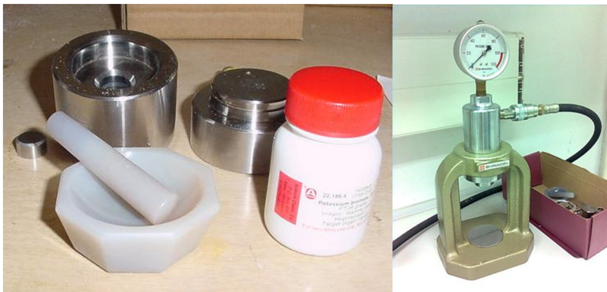
Slika 14. Kalupi i preša za izradu KBr pastila
