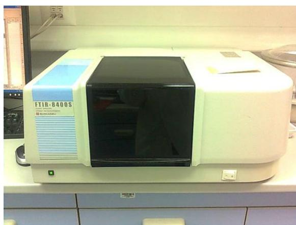
Slika 18. Infracrveni spektrofotometar s Fourierovom transformacijom signala, FTIR-8400s
