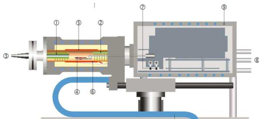
Slika 20. Dijelovi TG/DSC STAR1 uređaja: 1 - pregrade, 2 – ulaz plina , 3- izlaz plina, 4 – senzor temperature, 5 – grijач peći, 6 – senzor temperature u peći , 7 – elektrovaga, 8 – priključak za zaštitu i pročišćavanje plinova, 9 – termostatirana ravnotežna komora.
