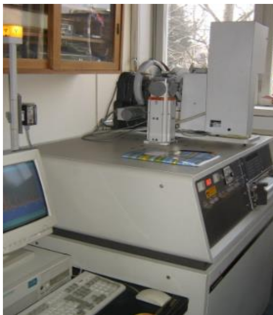
Slika 23. Rentgenski difraktometar za polikristale za rad pri sobnoj temperaturi. [51]
