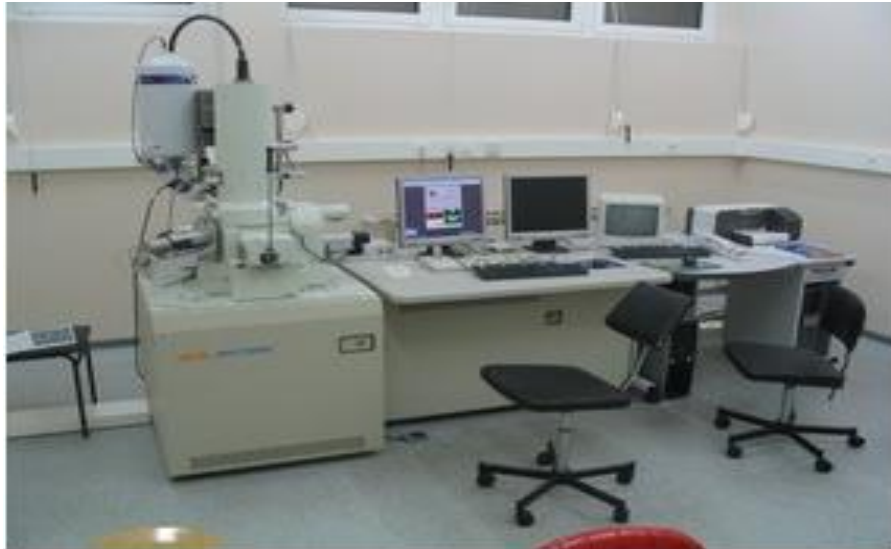
Slika 5. Skenirajući elektronski mikroskop. [20]
