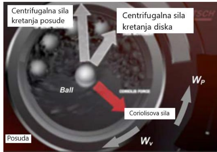
Slika 4. Prikaz sile koje djeluju u reakcijskoj posudi planetarnog kugličnog mlina.
