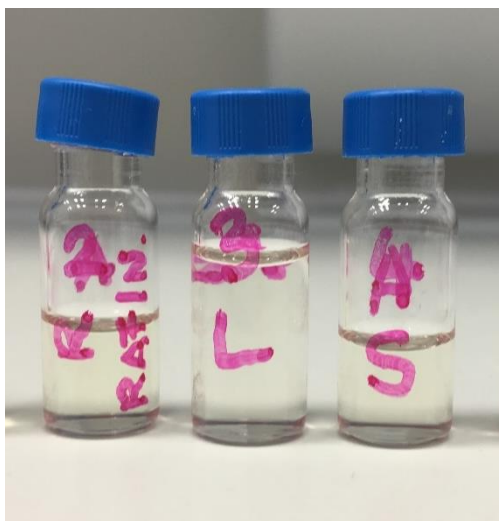
Slika 16. Uzorci ulja nakon sušenja s \text{Na}_2\text{SO}_4 spremni za analizu plinskom kromatografijom.
