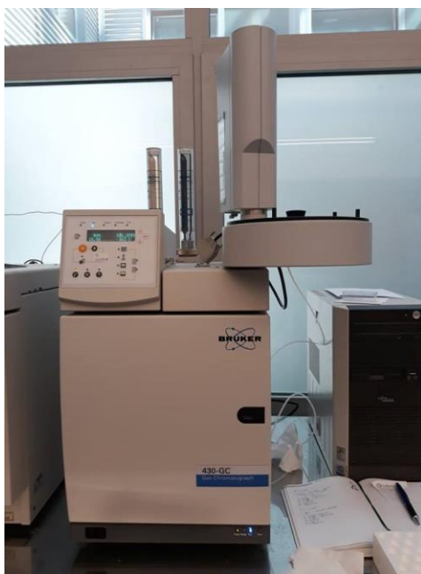
Slika 11. Plinski kromatograf tvrtke Bruker, model 430-GC.
