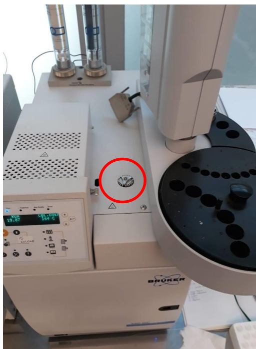
Slika 18. Mjesto injektiranja uzorka (označeno crvenim krugom).
