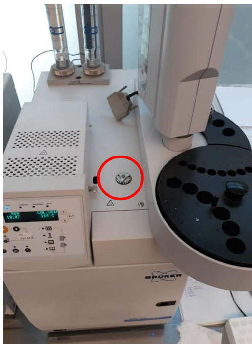
Slika 18. Mjesto injektiranja uzorka (označeno crvenim krugom).
