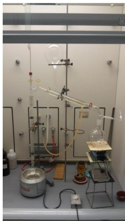
Slika 3. Aparatura za destilaciju suhog diklormetana
