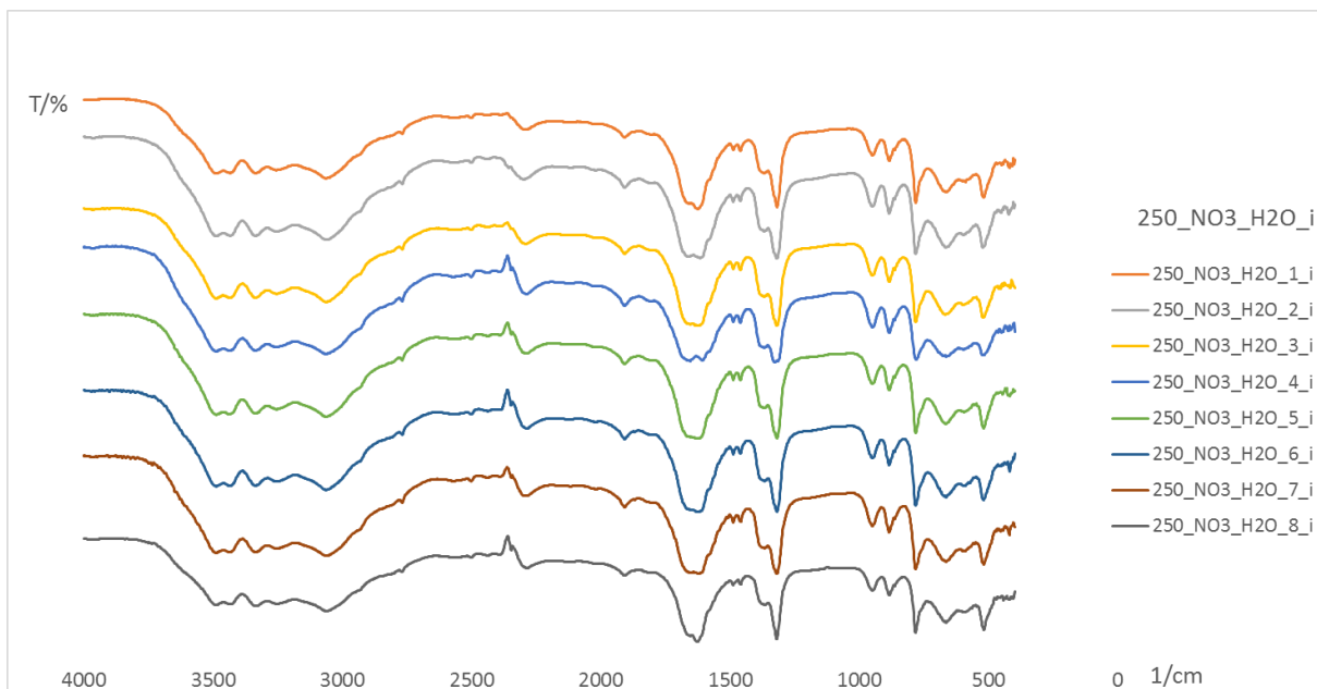
Slika 20. IR spektar osam uzoraka s dodatkom vode, poslije ispiranja, pri brzini 250 okr/min
