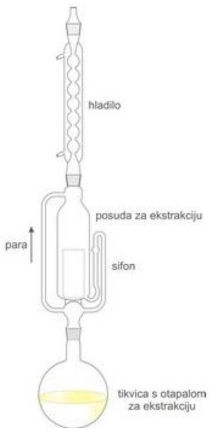
Slika 4. Soxhlet aparatura [9].
